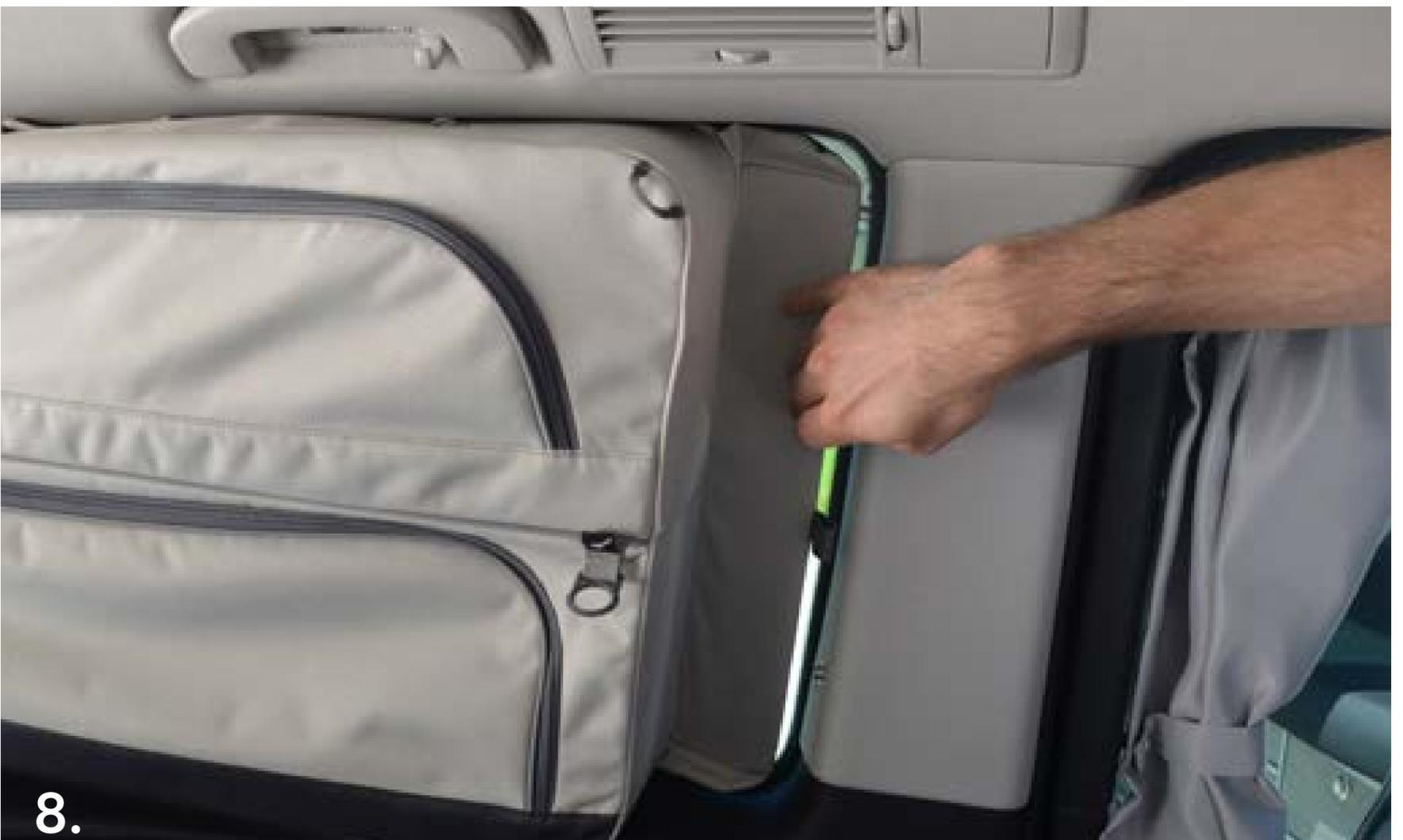
Klappen Sie nun die Lasche nach hinten ans Fenster und drücken diese so an, dass sie hinter der Gummilippe Halt findet (Bild 8).
