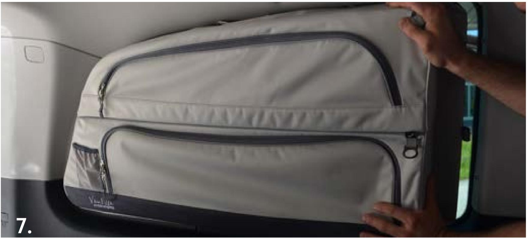
Schieben Sie nun die Tasche in Richtung Heck. Die Aussparung passt über den (falls vorhanden) Fenstermotor (Bild 7).
